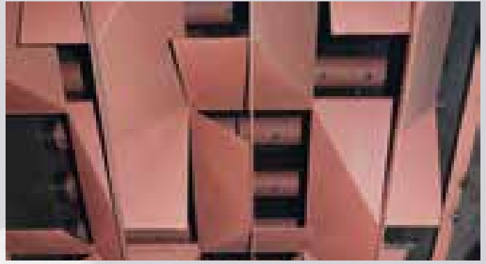
Mixer per gas di combustione per denitrificazione
